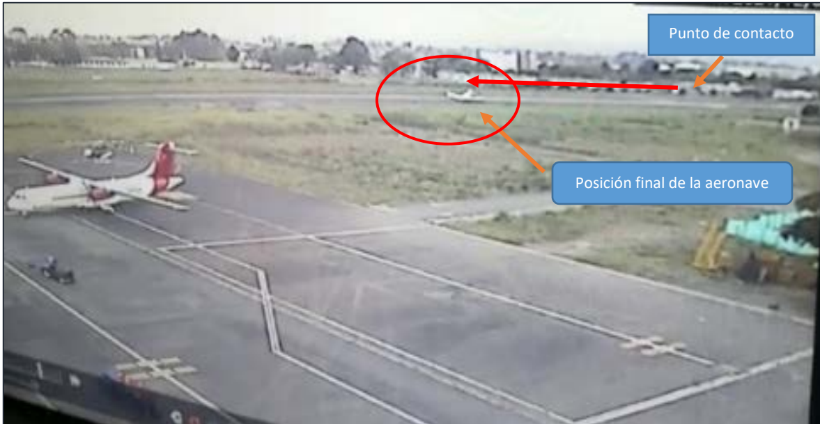
Fotografía No.1 - Trayectoria del aterrizaje y posición final del HK5136G
