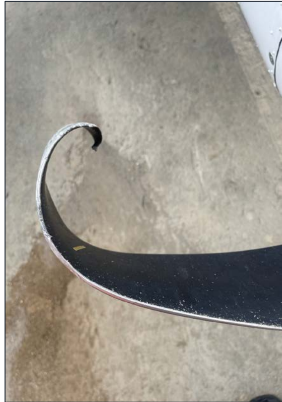
Fotografías No. 3 y 4 - Daños en las palas de las hélices.
