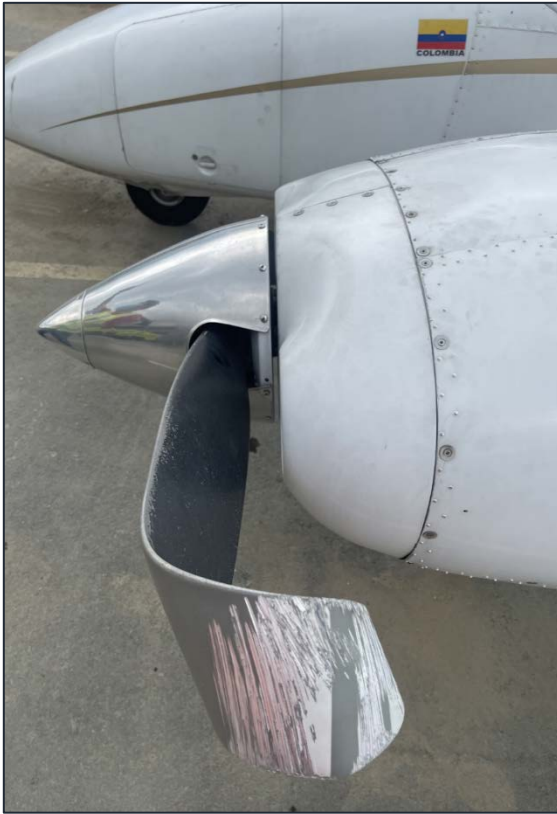
Fotografías No. 3 y 4 - Daños en las palas de las hélices.
